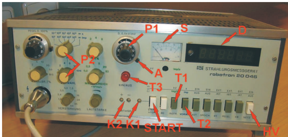
Obrázek 1: Popis ovládacích prvků G-M čítače
