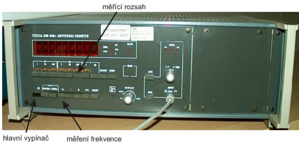
Obr. 3: Čítač pro určení frekvence vlnění. Frekvence je zobrazovaná v kHz.
